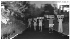
Bei schlechten Lichtbedingungen, zum Beispiel nachts, schaltet die Kamera automatisch in den Schwarz/Weiß-Betrieb um. Die Sicht wird zusätzlich durch die integrierte Infrarotbeleuchtung unterstützt. Die Kamera besitzt einen eingebauten Infrarot-Sperrfilter (IR-Cut-Filter). Damit werden störende Einflüsse der IR-Strahlung auf die Abbildungsqualität des Sensors vermieden.
